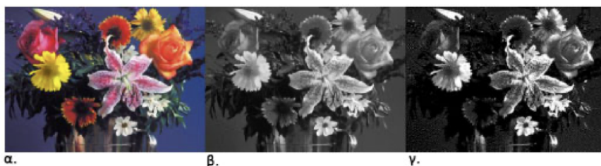
Εικόνα 2.4. Τυπικά παραδείγματα κατηγοριών εικόνων: έγχρωμη (α), μονοχρωματική με αποχρώσεις του γκρι (β) και δυαδική (γ) [Ελλ21]
