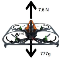
Εικόνα 3.4 Παράδειγμα ώσης και βάρους ενός drone [4]
