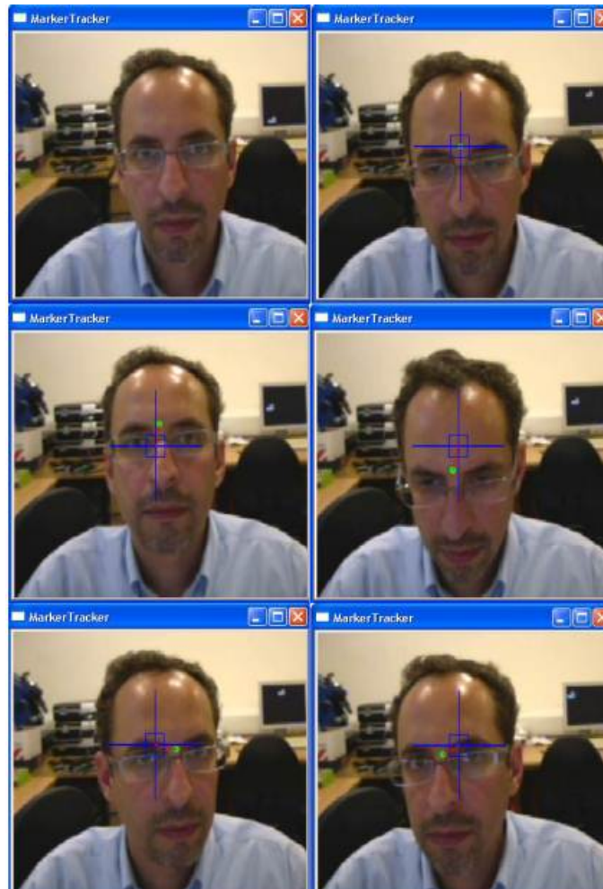
Εικόνα 29. Εντοπισμός και ανίχνευση των χαρακτηριστικών του προσώπου και εκτέλεση της αντίστοιχης εντολής με βάση τη χειρονομία του κεφαλιού (το ίδιο συμβαίνει με το χέρι). Η πράσινη κουκίδα δείχνει την μετατόπιση, η οποία αντιστοιχεί και στην αντίστοιχη εκτέλεση εντολής.
