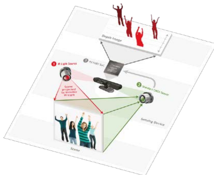
Εικόνα 4. Τρόπος λειτουργίας Kinect.
