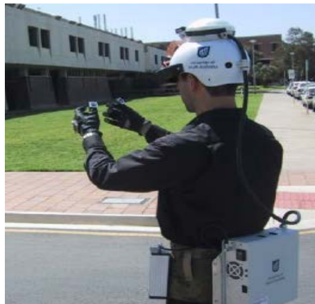
Εικόνα 4. Σύστημα Tinmith (wearable-computer-system) (Thomas, Demczuk, Piekarski, Hepworth, & Gunther, 1998)
